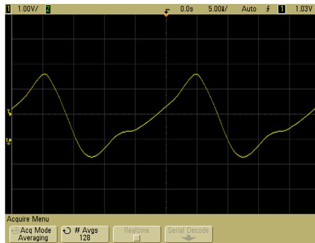
**Figura 39** Usadas 128 amostras no cálculo da média para reduzir ruído aleatório
